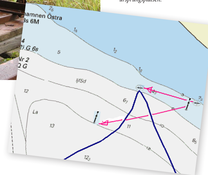
De röda pilarna visar hur vraket och västpricken har flyttat sina positioner från deras ursprungliga lägen. Vraket har sannolikt aldrig legat på ursprungsplatsen.
