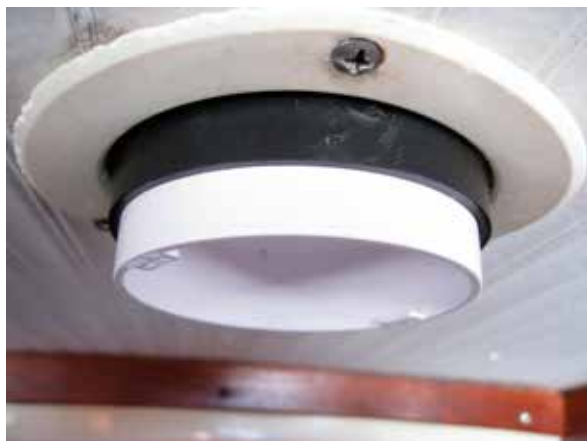
Figur 3: Ventilatorn sedd inifrån. Stängningsanordningen för överbrytande sjö sticker ner en bit.
